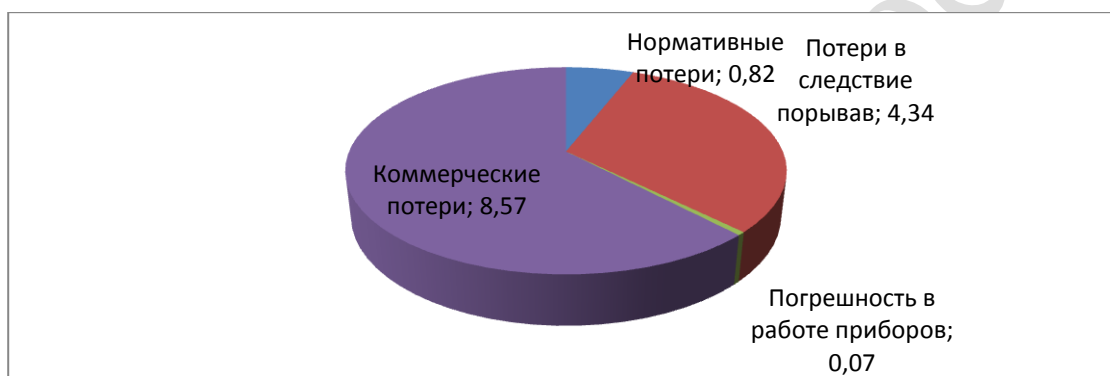
Рис. - Структурные составляющие потерь питьевой воды при ее производстве и транспортировке
